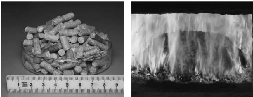
左：エリアンサス「JES1」を利用して作成したバイオマス燃料ペレット
