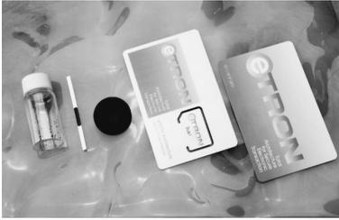
図2：アクティブ型の電子タグ
