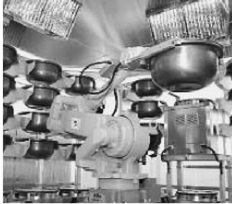
業務用IH炊飯ラインがCO<sub>2</sub>40%削減を実現。2台ある大型搬送ロボットの一台。
