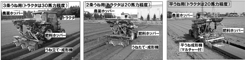
図3 「うね内部分施用法」を実現する「うね内部分施用機」
